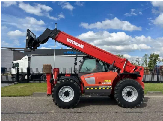
Figure 3 : exemple d'engins utilisés sur le chantier. Chariot manuscopique Manitou (gauche) et skid à chenilles Bobcat (droite)
